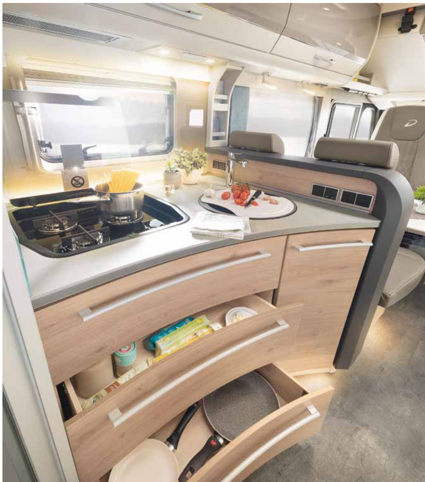
Les grands tiroirs coulissants se verrouillent automatiquement au démarrage. La hotte aspirante permet d'évacuer les odeurs de cuisson à l'intérieur du véhicule
