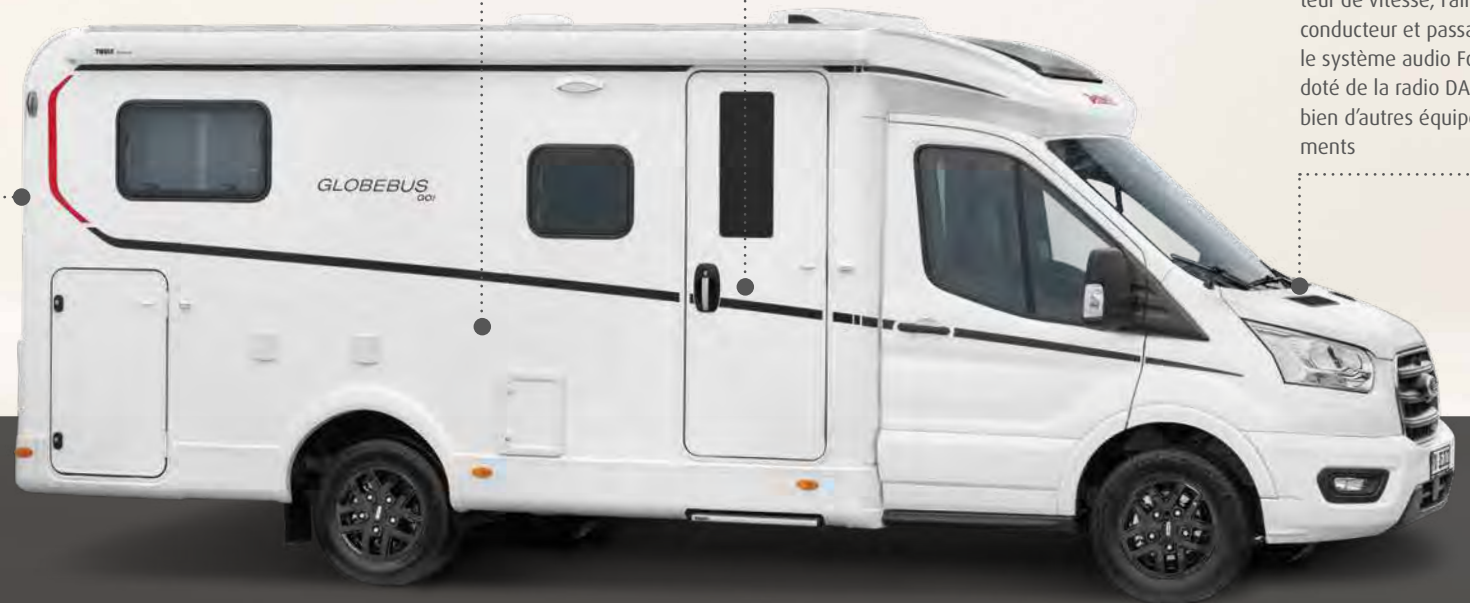
Toit, face arrière et parois latérales en polyester renforcé de fibres de verre
