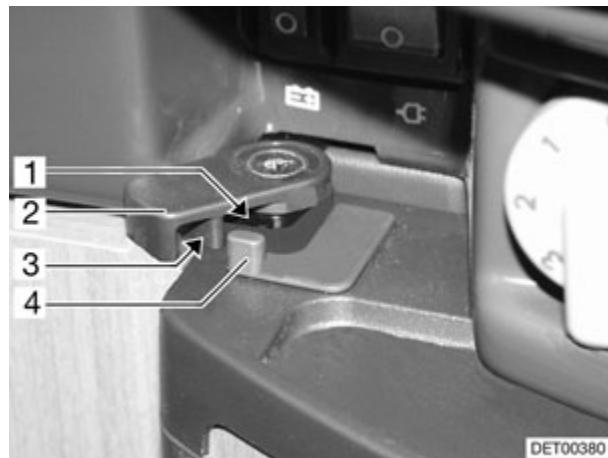
Fig. 123 Dispositif de verrouillage de la porte du réfrigérateur (variante 2)
