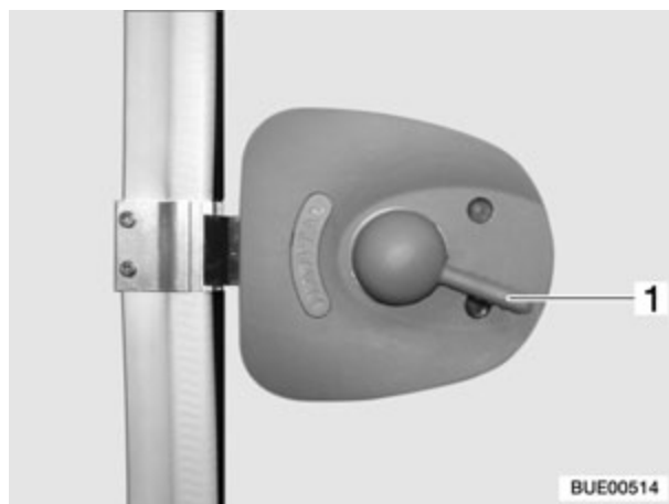
Fig. 22 Serrure de la porte cellule, à l'intérieur, ouverte
