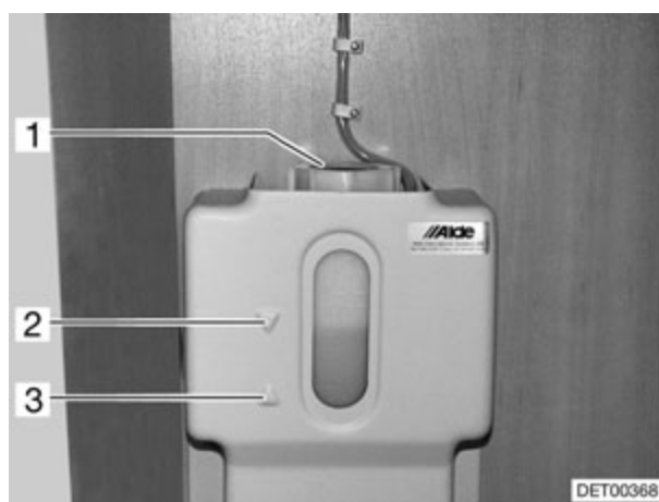
Fig. 155 Vase d'expansion pour le chauffage à eau chaude
