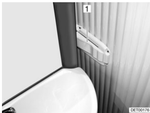
Fig. 146 Toilettes Vario, blocage de la paroi de douche
