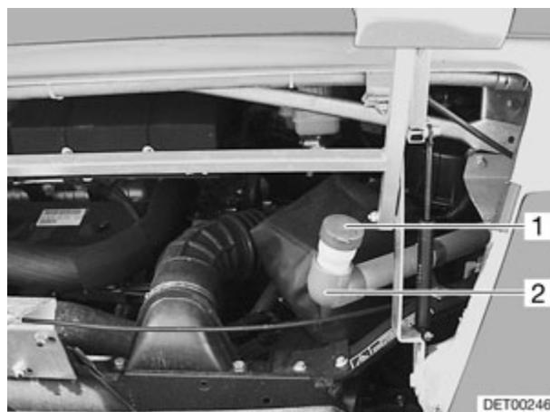
Fig. 19 Réservoir pour liquide d'essuie-glace
