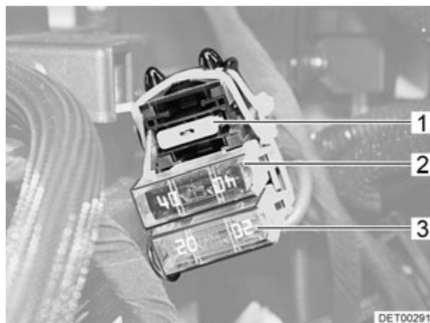
Fig. 118 Fusibles de la batterie de démarrage
