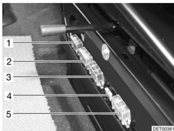
Fig. 120 Fusibles devant le siège conducteur
