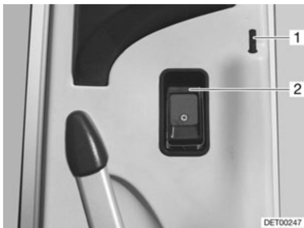
Fig. 26 Serrure de la porte, à l'intérieur (variante 3)
