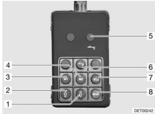
Fig. 8 Télécommande suspension pneumatique de l'essieu arrière
