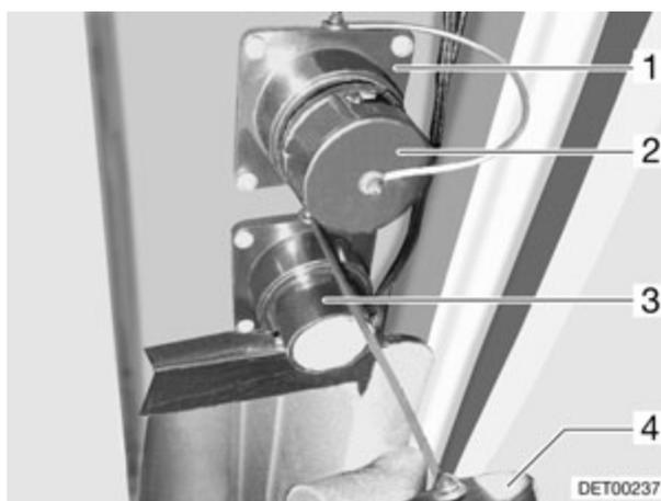
Fig. 172 Bec d'écoulement d'eau et bec d'écoulement des eaux usées
