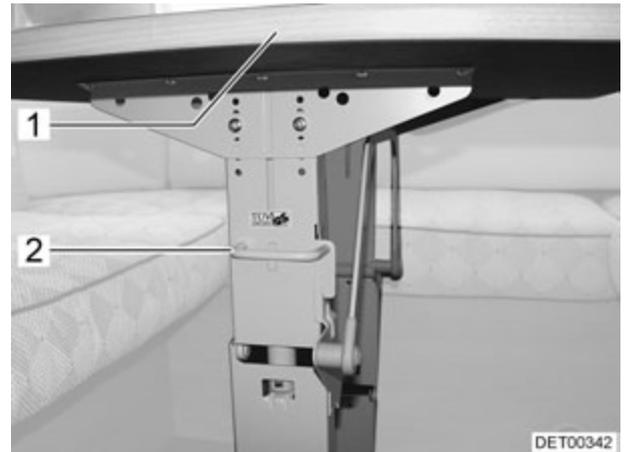
Fig. 62 Dispositif de verrouillage de la table pivotante (variante 1)
