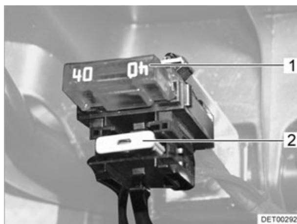
Fig. 119 Fusibles de la batterie de cellule
