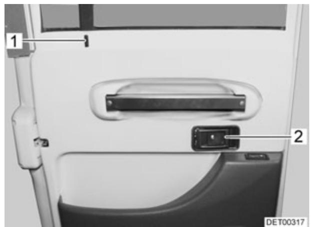
Fig. 25 Serrure de la porte, à l'intérieur (variante 2)
