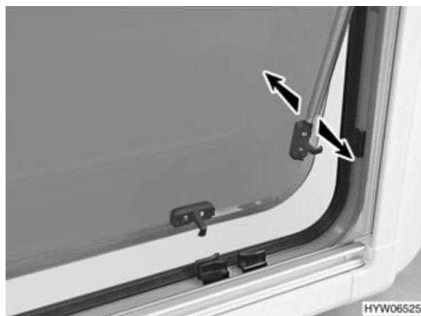
Fig. 38 Fenêtre projetante, rail télescopique (variante 2)
