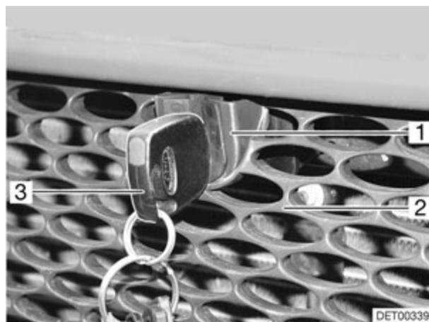
Fig. 18 Déverrouillage du capot moteur Fortero
