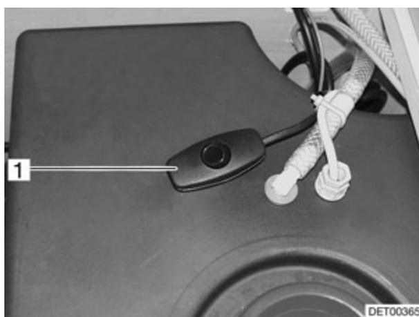
Fig. 165 Interrupteur pour pompe à eau
