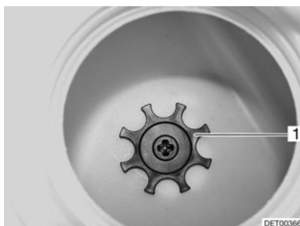
Fig. 171 Bouchon de fermeture (vissé)
