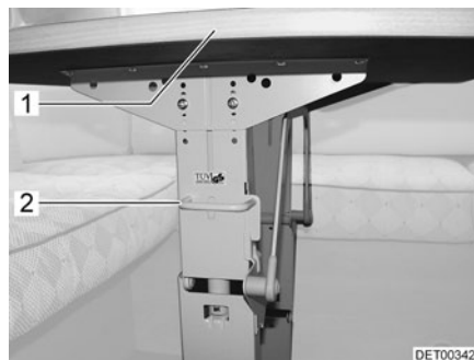
Fig. 52 Dispositif de verrouillage table pivotante avec étrier
