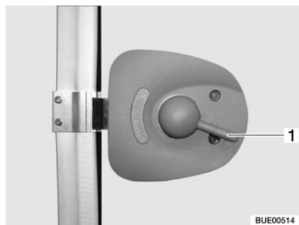
Fig. 23 Serrure de la porte cellule, à l'intérieur, ouverte
