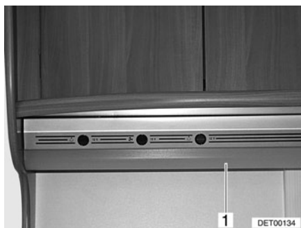
Fig. 168 Eclairage de la cuisine
