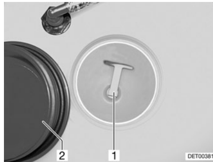
Fig. 156 Couvercle de fermeture du bec de remplissage d'eau fraîche
