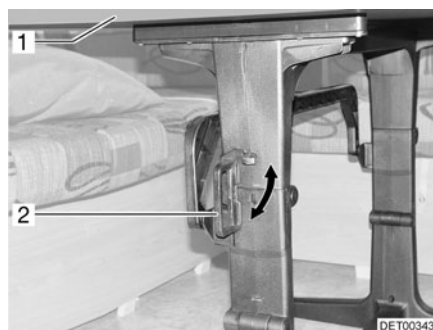
Fig. 62 Dispositif de verrouillage table pivotante à monture en plastique
