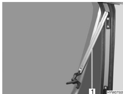
Fig. 39 Fenêtre projetante avec bras automatiques, ouverte
