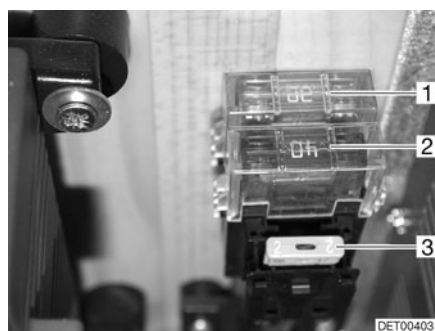
Fig. 141 Fusibles de la batterie de cellule (Renault)
