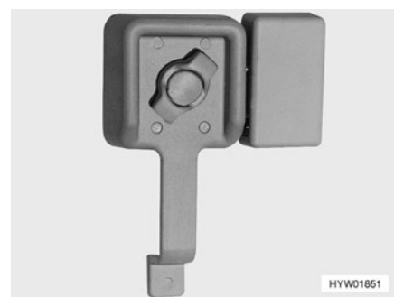
Fig. 32 Serrure de la porte cellule, à l'intérieur, verrouillée
