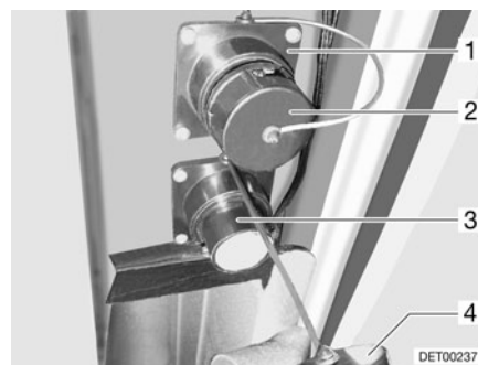
Fig. 200 Bec d'écoulement des eaux usées
