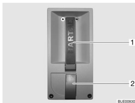
Fig. 34 Serrure de la porte cellule, à l'intérieur
