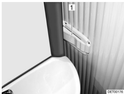
Fig. 237 Toilettes Vario, blocage de la paroi de douche
