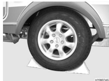
Fig. 196 Bloquer le véhicule
