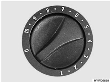
Fig. 116 Bouton tournant du chauffage à air chaud
