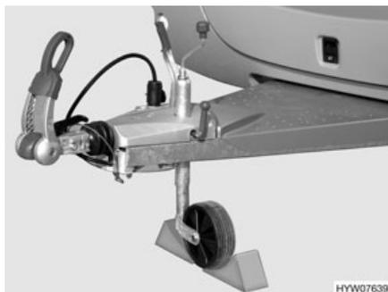
Fig. 195 Bloquer la roue d'appui
