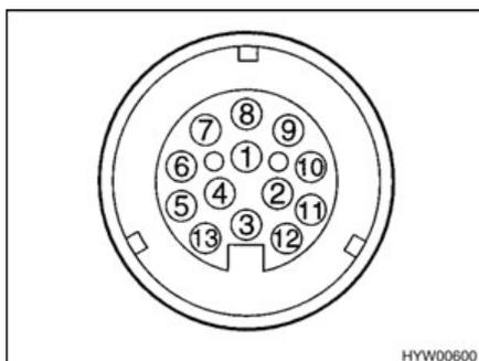
Fig. 112 Coupe de la prise du véhicule tracteur (système à 13 pôles de Jaeger)
