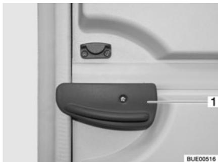
Fig. 25 Levier de verrouillage sur la partie inférieure de la porte
