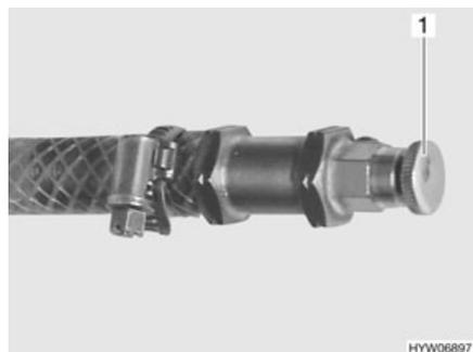
Fig. 182 Soupape de purge pour le chauffage à eau chaude
