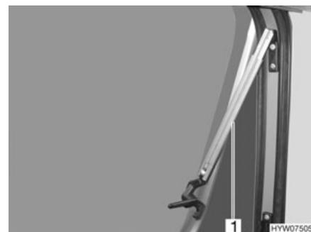
Fig. 39 Fenêtre projetante avec bras automatiques, ouverte
