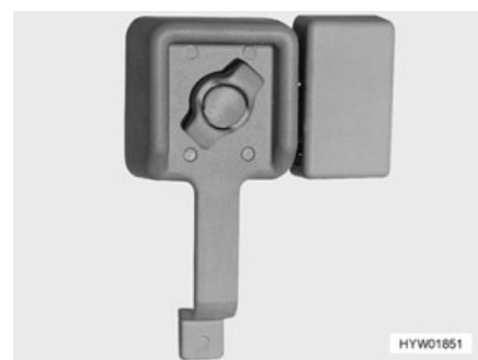
Fig. 37 Serrure de la porte cellule, à l'intérieur, verrouillée
