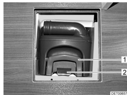
Fig. 262 Accès réservoir pour matières fécales, ouvert
