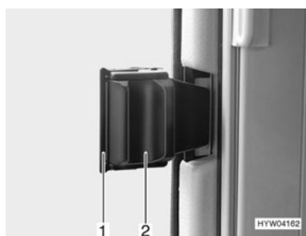
Fig. 49 Fenêtre coulissante avec verrouillage coulissant
