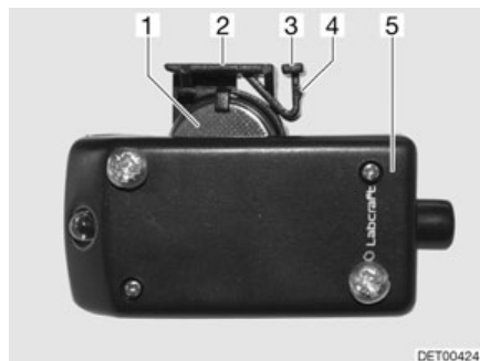
Fig. 282 Eclairage de la penderie avec compartiment de pile ouvert
