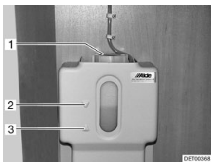
Fig. 267 Vase d'expansion pour le chauffage à eau chaude
