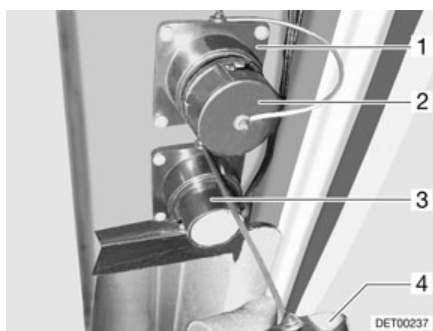
Fig. 234 Bec d'écoulement d'eau et bec d'écoulement des eaux usées
