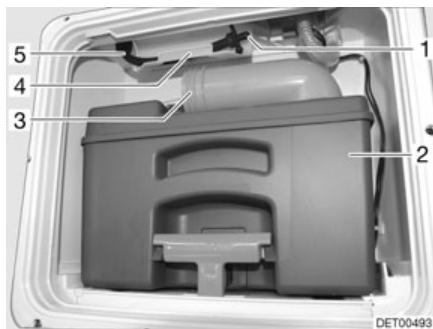
Fig. 265 Tuyau d'écoulement réservoir d'eau toilettes
