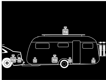
Fig. 3 Répartition incorrecte des charges
