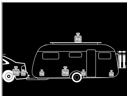
Fig. 3 Répartition incorrecte des charges
