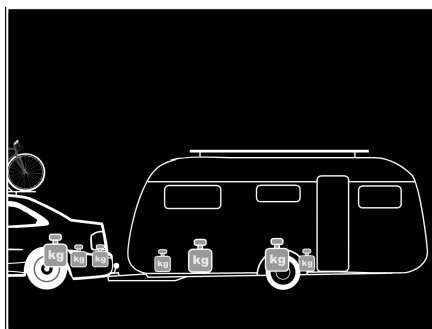
Fig. 4 Répartition correcte des charges
