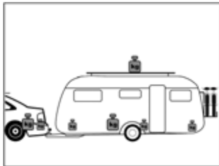
Fig. 3 Répartition incorrecte des charges
