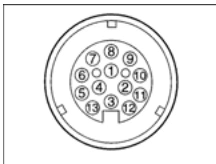
Fig. 97 Vue sur la prise de courant du véhicule tracteur (système à 13 pôles de Jaeger selon DIN EN 1648-1)
