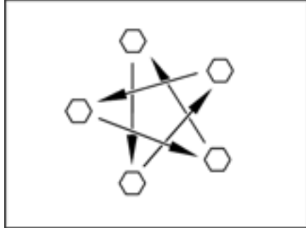
Fig. 170 Serrer en croix les écrous ou les boulons de roue
